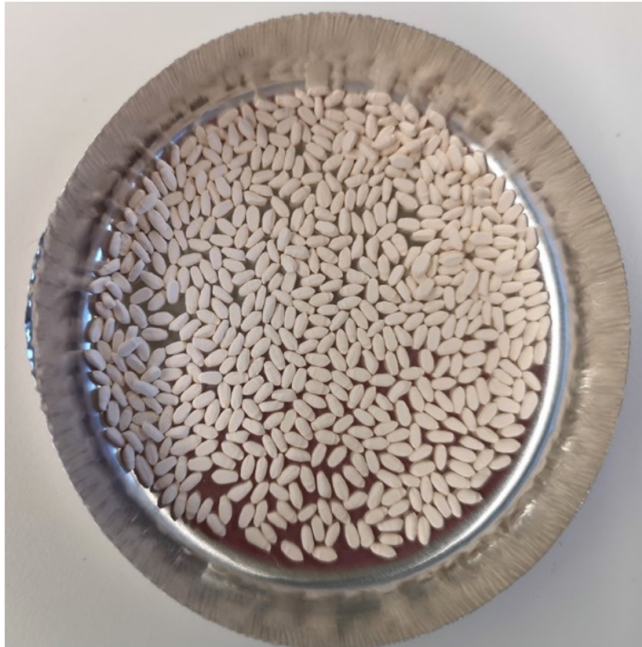
FIGUUR 2.1 ZEOLIETKORRELS ZOALS TOEGEPAST IN EEN VAST BED REACTOR
