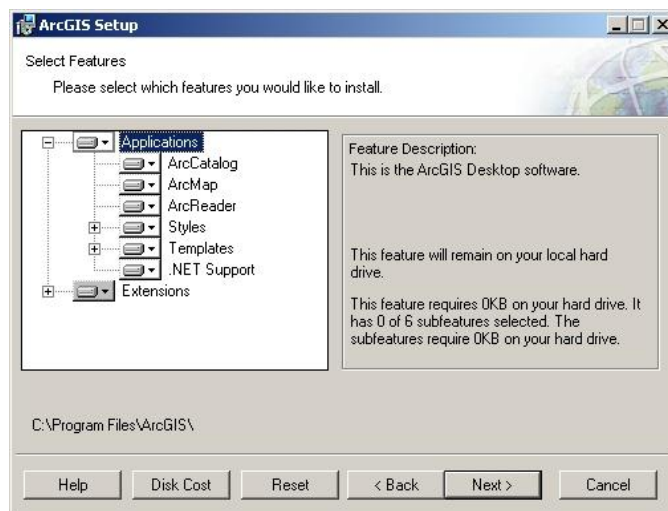
FIGUUR 3-1 SETUP-VENSTER VAN ARCGIS MET DE OPTIE OM .NET SUPPORT TOE TE VOEGEN
